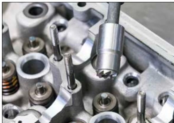
*Limpieza profesional del eje del inyector, de la punta del inyector y de la apertura de la aguja de la boquilla*
