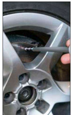
Realización de la medición sin desmontar la rueda
