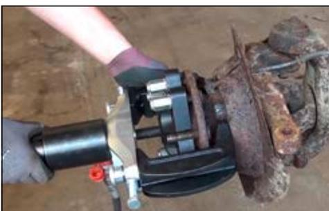
**Cubos de rueda SUV / monovolumen con 6 y 8 pernos de anclaje Ajustable de forma universal hasta un máximo de 180 mm de diámetro**
