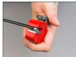
Posicionamiento del conducto para raspar el revestimiento
